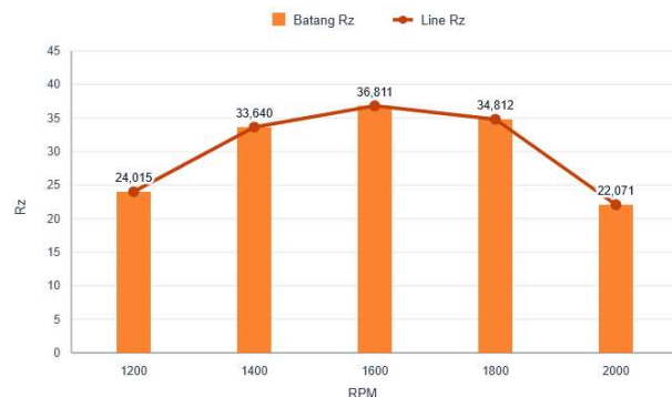
Grafik 5. Kecepatan Spindel vs Rz
