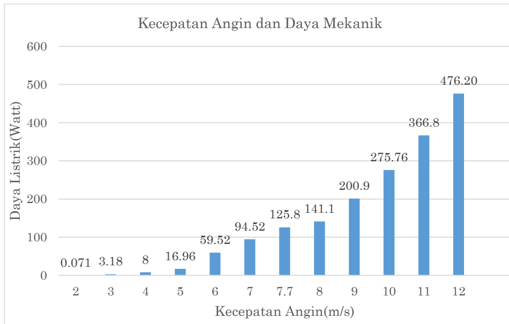
Gambar 5. Hubungan antara kecepatan angin dan daya mekanik
