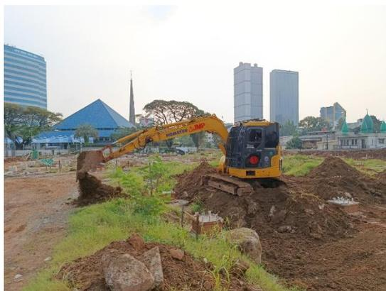
**Gambar 1 Excavator mini (Komatsu PC78US)**
