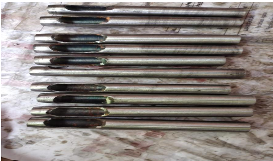
Gambar 2. Produk pipa yang sudah di carburizing.
