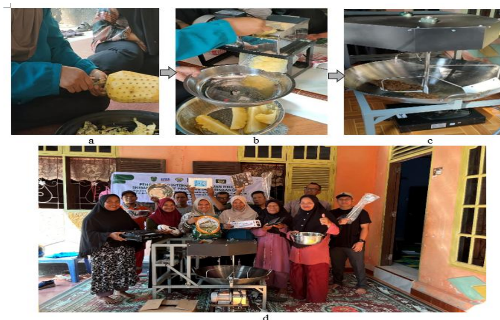
Gambar 3. Penerapan teknologi tepat guna pada proses produksi selai nanas: (a) penggunaan pisau khusus pengupas nanas, (b) penggunaan mesin pamarut nanas, (c) penggunaan mesin pengaduk selai berbahan stainless, dan (d) penyerahan serta instalasi peralatan kepada kelompok mitra.
