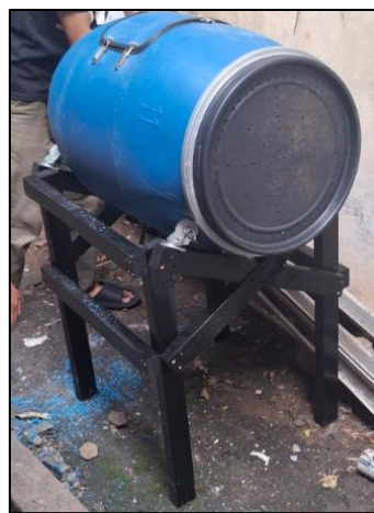
Gambar 3. Alat roller composter guna proses pematangan media tanam
