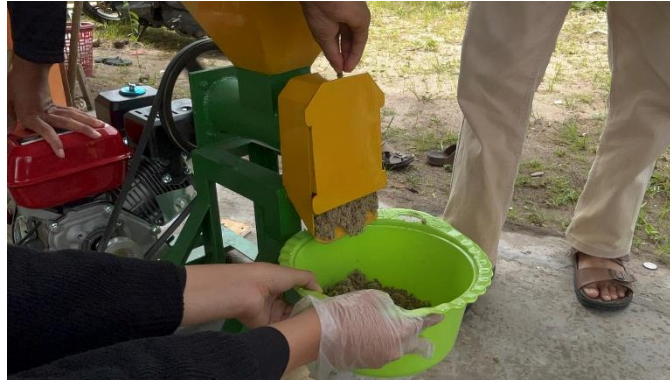
Gambar 1. Perakitan alat dan simulasi trial and error alat pencetak pakan ikan
