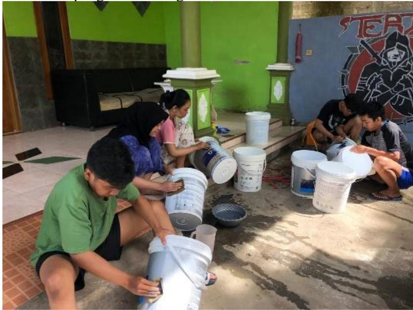
**Gambar 2.** Proses pengamplasan bagian badan tong Cat
